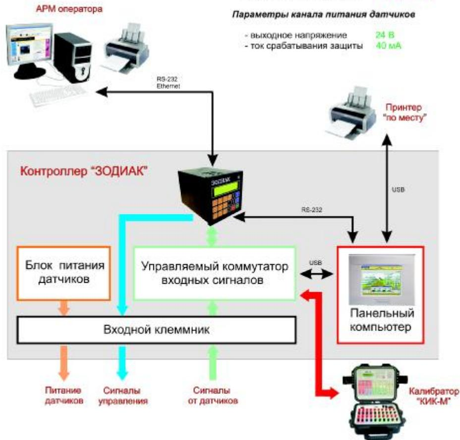
Кроме того, внутри корпуса может быть установлен управляемый коммутатор входных сигналов, который позволяет проводить автоматическую калибровку, диагностику и поверку контроллера с помощью калибратора измерительных каналов КИК-М.
